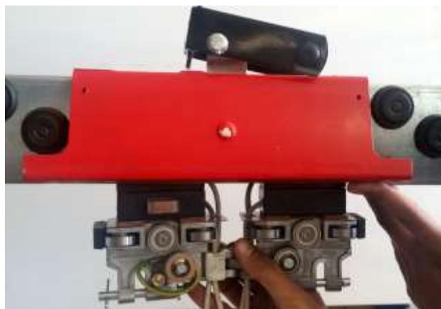
Slika br.16 Ubacivanje oduzimača, zatim se pomeri u desno ili levo , spuste se stranice
