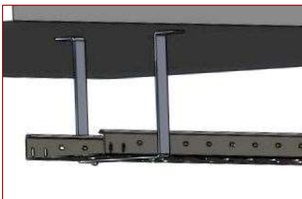
Slika br.6 Montaža na plafon PNK E90 pomoću plafonskog nosača
