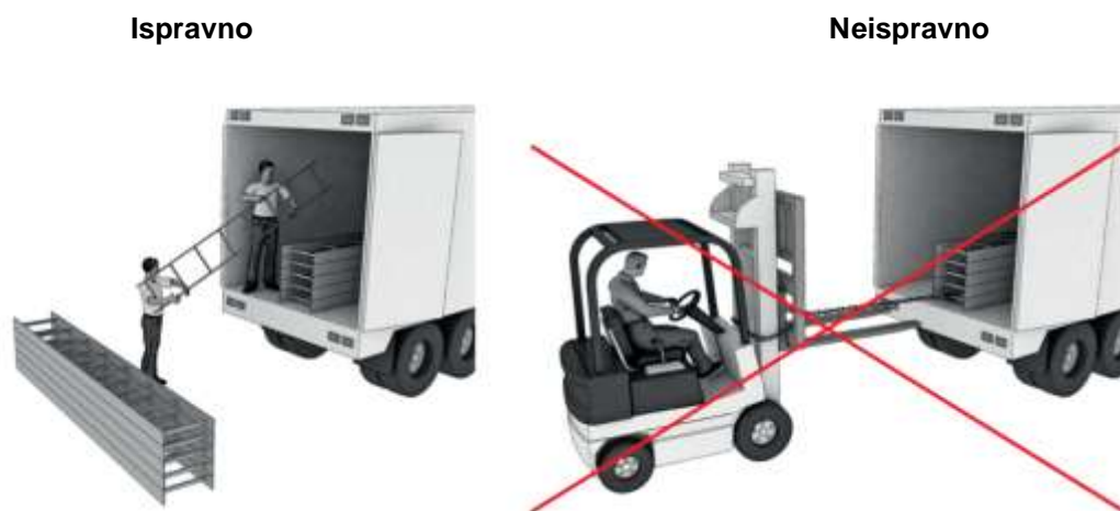
Slika 1: Istovar kablovskih nosača iz kamiona
