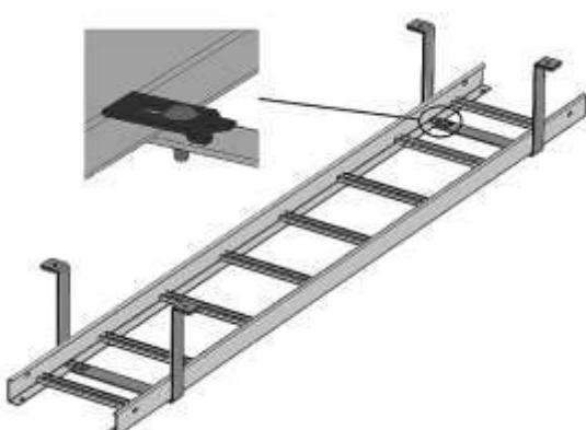
Kod ovog načina kačenja nosača kablova koristi se plafonski „U“ nosač koji se za plafon pričvršćuje pomoću anker vijka ili metalnog tipla. Veza nosača kablova i plafonskog nosača se ostvaruje pomoću pločice za vezu i torban vijka M6x15 (komplet)
