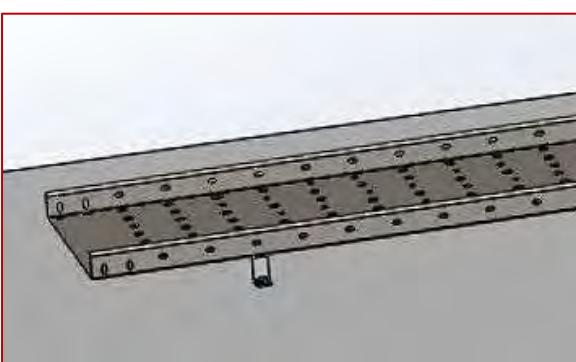
**Slika br.11** Montaža na pod pomoću podnog nosača
