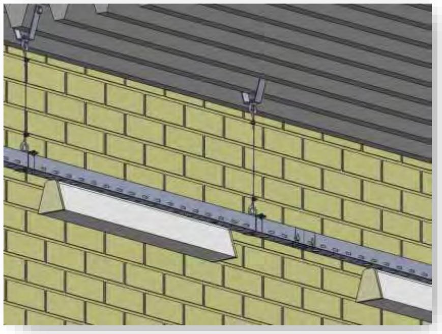
U slučajevima kada se u halama ne nalazi standardni plafon već trapezni, u tom slučaju nudimo kačenje rasvete pomoću trapeznog nosača i svih ostalih pratećih elemenata, koji su dati u daljem opisu, pri čemu je oslonce moguće postavljati na međusobnom rastojanju od 2m. Vezivanje trapeznog nosača na zid može se ostvariti korišćenjem vijka sa šestougaonom glavom odgovarajuće dužine, ili korišćenjem navojne šipke, pričvršćene navrtkama sa obe strane.
