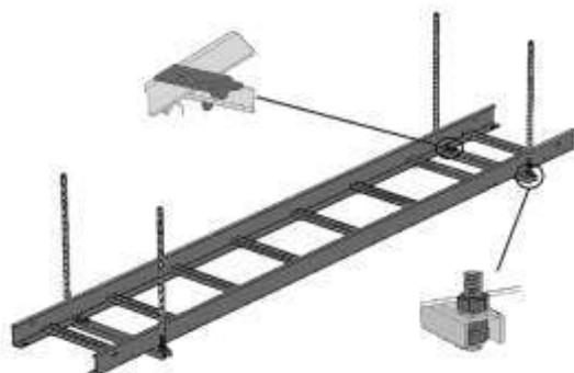
Postavljanje rešetkastog nosača kablova na plafon pomoću U nosača E90 i navojnih šipki
